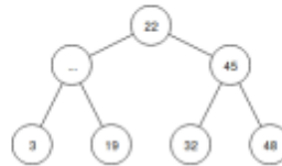
Figure 3: Arbre binaire de recherche
