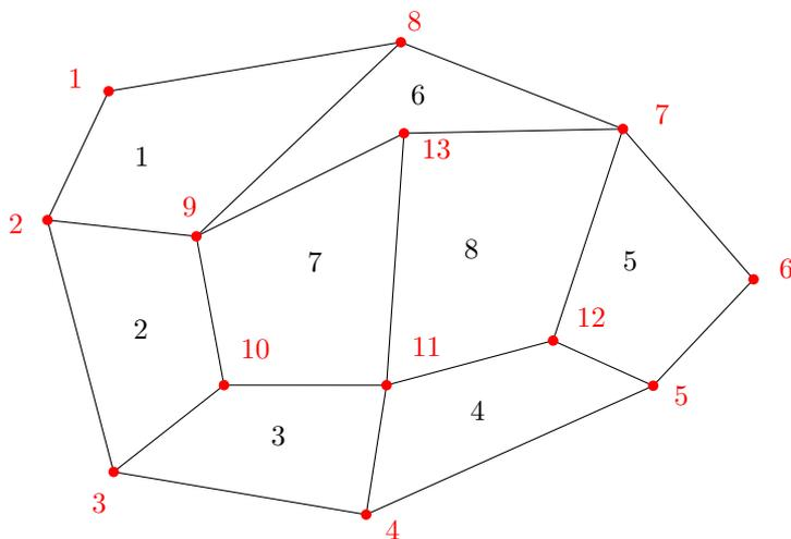
On suppose donné un maillage d'un polygone à  $k$  cotés en  $q$  quadrilatères. Les quadrilatères ne sont pas forcément convexes, et peuvent utiliser des sommets intérieurs au polygone. Dans la figure on a  $k = 8$ ,  $q = 8$  et  $n = 13$ .
